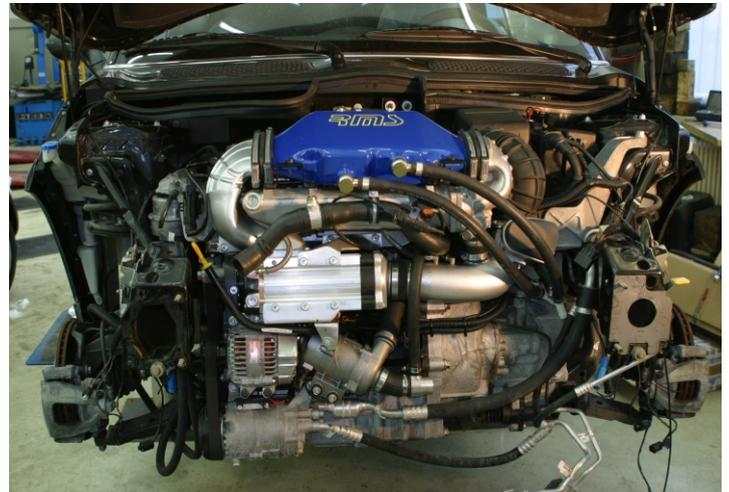
Mit den WLLK - Satz, 54mm Laderad auf dem original Verdichter und einer neuen Steuergerätoptimierung erreicht man 225PS/270 Nm; beim Works getunten Cooper S knapp 245PS / 270Nm.
